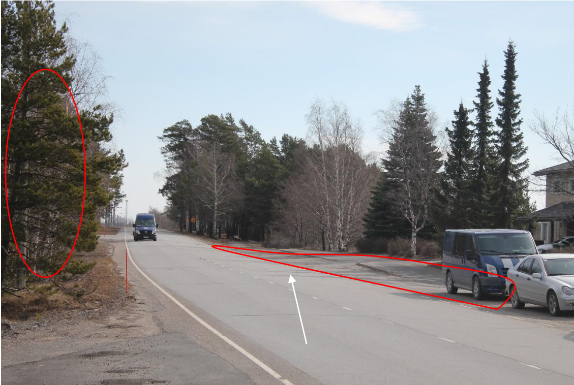
Pos 1 / Kuva 3. Poistuminen satamasta portin EK1 kautta. Merkitty alue on pidettävä vapaana kuljetusten ajan, pysäköinti kielletty. Merkittyjä puita on kaadettava.
