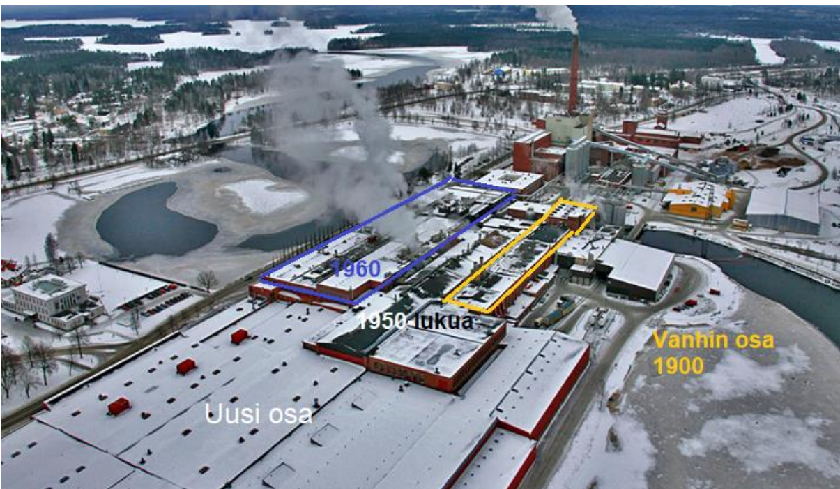
Paperitehtaan kokonaisuus on rakentunut yli sadan vuoden aikana. Tärkeimmät laajentumis- vuosikymmenet on rajattu oheiseen viistoilmakuvaan. Rakennusmassan eteläisin punatiiliseinämä edustaa varhaisinta rakennusjaksoa vuosisadan vaihteesta (keltainen). Tehtaankadun varrella on suurimmat konesalit 1960-luvulta (joita on uudistettu myöhemmin) ja näiden väliin jää 1950-luvun, ja osittain 1930- luvun rakennusosat. Uusinta rakennuskantaa edustaa jalostamo (matalampi kattoalue kuvan etuosassa).
