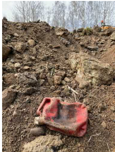
KK3 Noin metrin syvyydestä, kuopan leventämisen yhteydestä muovijätettä ja haiseva purkki.
