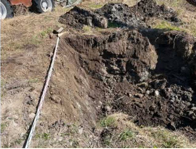
KK9 kuopan pohja kiveä. Kuopan leveys 4m. Todennäköinen kallio.
