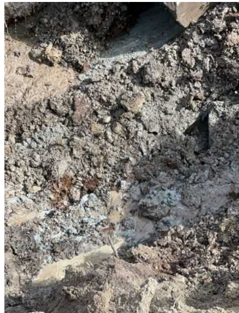
KK2 sinertävä silttikerros plus 4m syvyydessä
