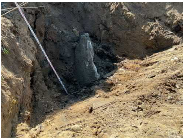
KK4 pitkulan muotoinen kivi noin 3,5m syvyydessä. Käännettiin ja alta savea vielä puoli metriä.
