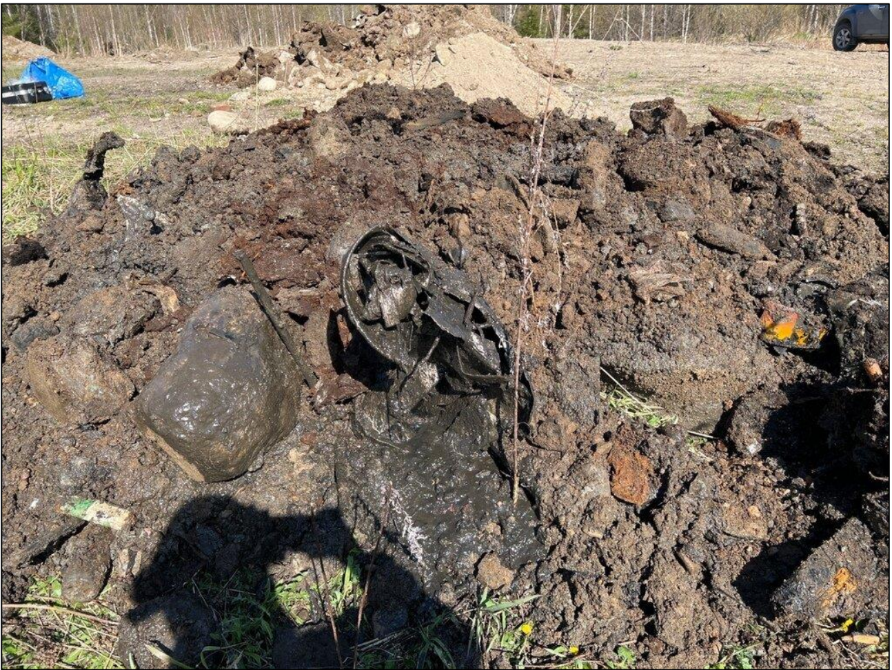
Kuva 4 Hajonnut tynnyri ja tummaa nestemäistä ainetta koekuopassa KK7
