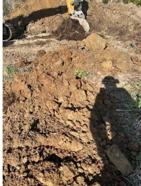
KK6 6-7 louhekvikerroksen alapuolinen hiekka
