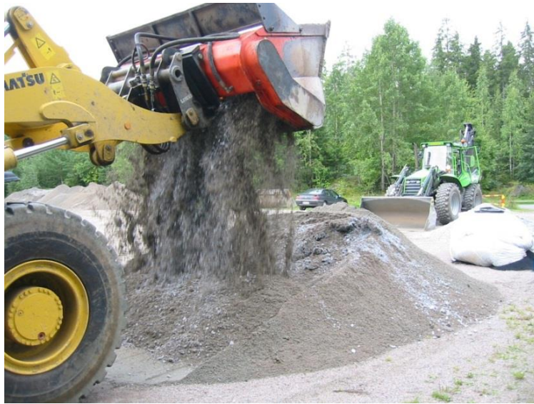
Kuva 10.1.2 Vaihtoehtoinen työtapa materiaalien sekoitus- ja homogenisointityölle on seulamurskainkauha.
