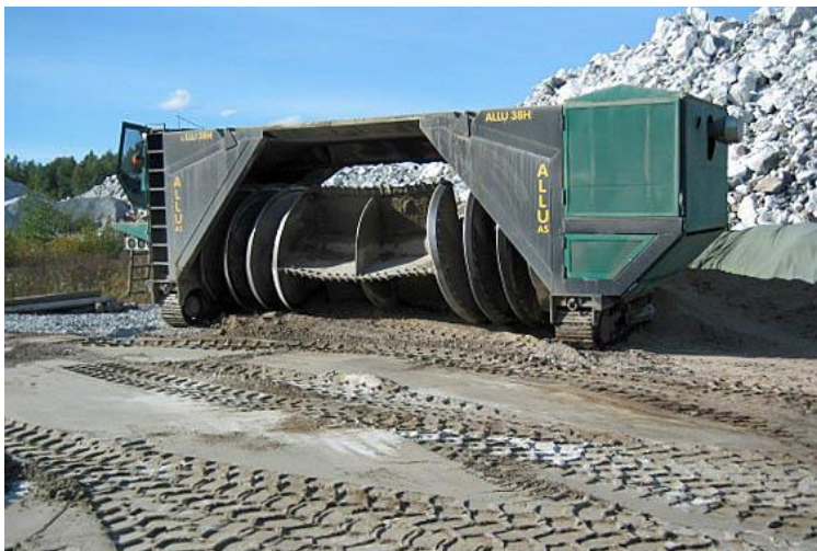
Kuva 10.1.1 Suositeltavampi työtapa materiaalien sekoitus- ja homogenisointityölle on aumasekoitin.
