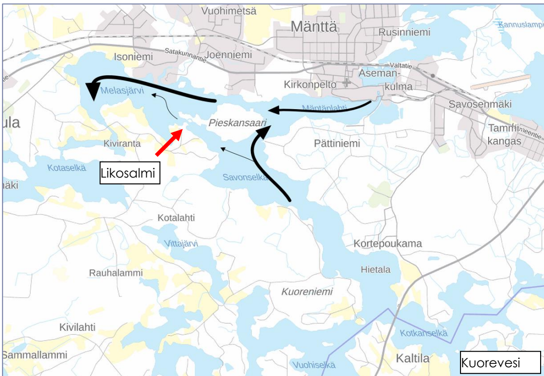
Kuva 3. Pieskansaaren alueen ja Likosalmessa veden virtaama väliaikaisen pengertien rakentamisen jälkeen. Pengertie estää veden virtauksen ja jääeroosion, minkä takia vesikasvillisuus lakastuu paikalleen ja vesikasvien biomassa kertyy salmeen, mikä aiheuttanut alueen voimakasta umpeenkasvua.
